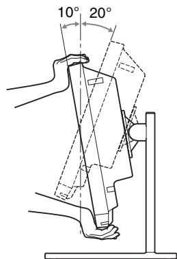
Kulmaa voidaan säätää pitämällä kiinni monitorin ylä- ja alareunasta.
