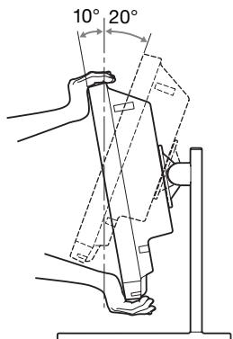
Úhel můžete upravit uchopením horní a spodní části monitoru.
