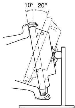
Puede ajustar el ángulo sujetando el monitor por la parte superior y por la parte inferior.
