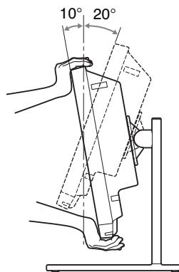
При регулировке угла наклона удерживайте
