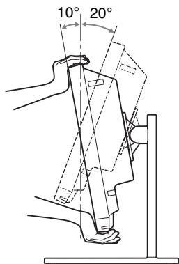
È possibile regolare l'angolazione afferrando il lato superiore e inferiore del monitor.
