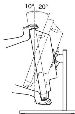
您可以握住顯示器頂端和底部以調整角度。
